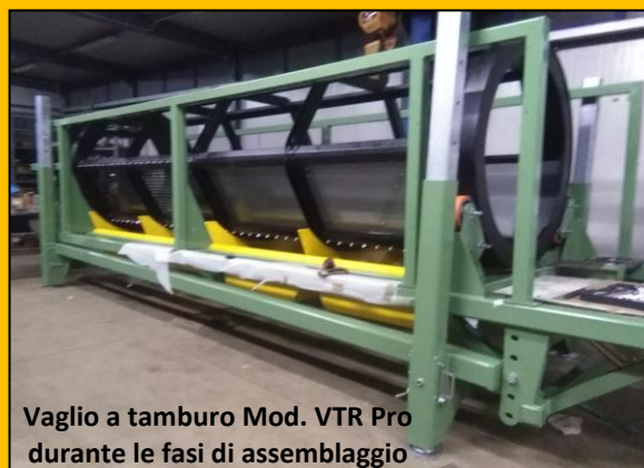
Vaglio a tamburo Mod. VTR Pro configurato tutto aperto pronto per il lavoro
