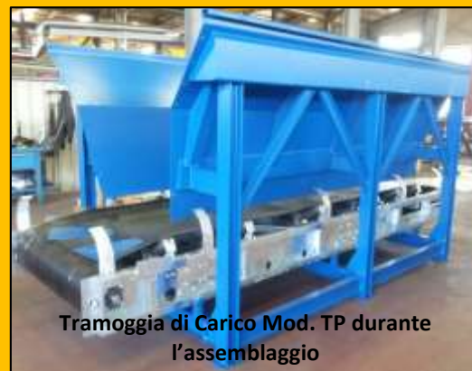
Tramoggia di Carico Mod. TP da 8,5 mc abbinata ad un trasportatore Mod. NB da mm 4600
