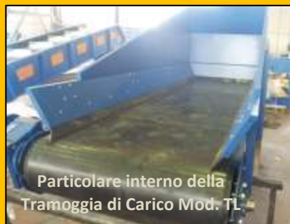
Tramoggia di Carico Mod. TL con capacità di 2 mc.
