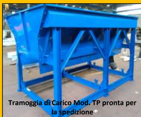
Tramoggia di Carico Mod. TP da 8,5 mc abbinata ad un trasportatore Mod. NB da mm 4600
